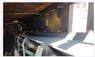
ریزش بار به صورت بکخواخت بر روی نوار نقاله C1
