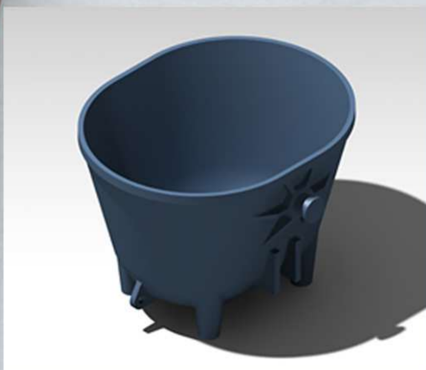
شکل ۳- مدل سه بعدی پاتیل حمل سر باره شرکت فولاد بوتیا ایرانیان.
