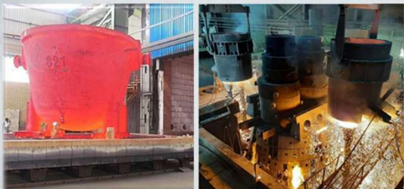
شکل ۲- ریخته گری و عملیات حرارتی قطعه پاتیل.
