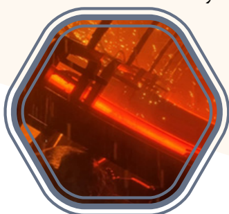
شمش‌های مذاب در ناحیه Fixed Bending Sector
