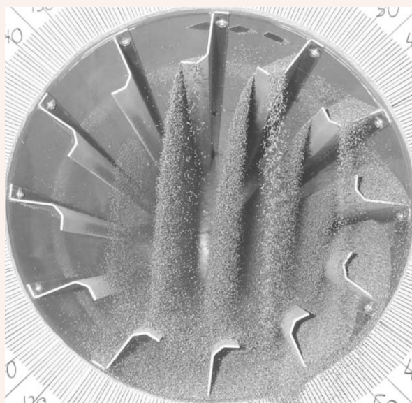
شکل ۲- پره‌های بالابرنده و نحوه ریزش بار در یک خشک کن چرخان
