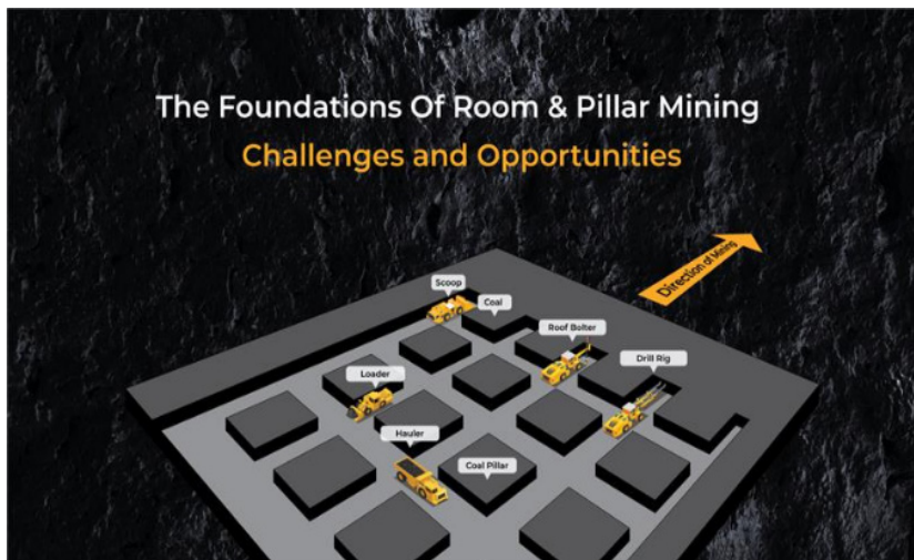
نمایی روش استخراج اتاق و پایه
